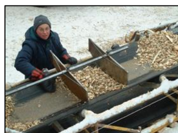
図 7. コンベヤサンプリングの一例
