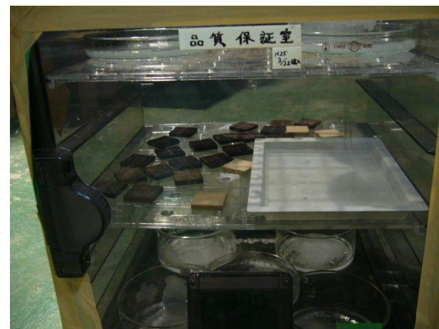
相対湿度75%(塩化ナトリウム飽和水溶液)調湿中。
