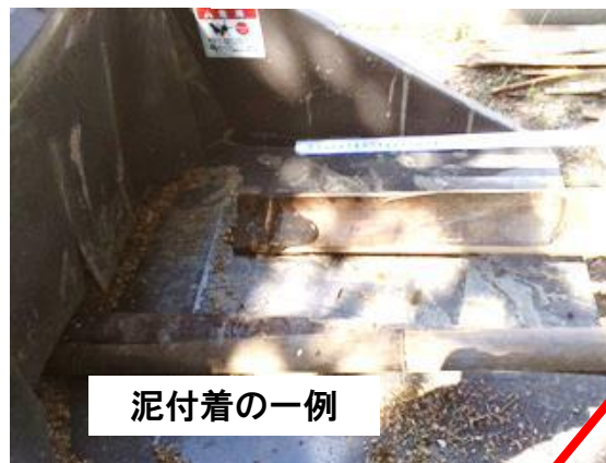
泥塗布 時間経過と共に砂利類 がバケツ下部に沈み込
