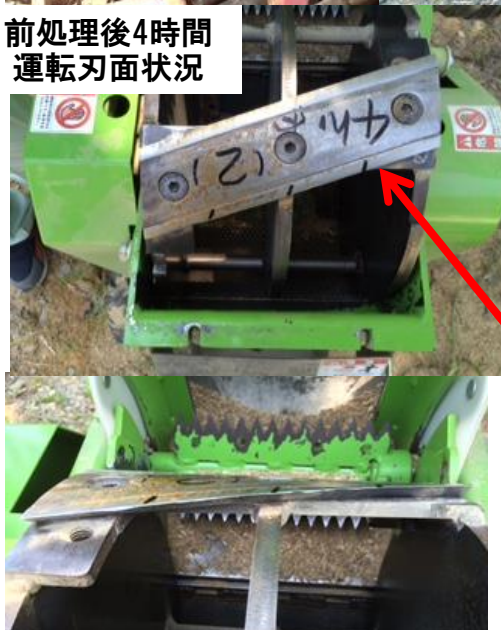
前処理後4時間運転刃面状況 めくれ程度で極端な摩滅無い
