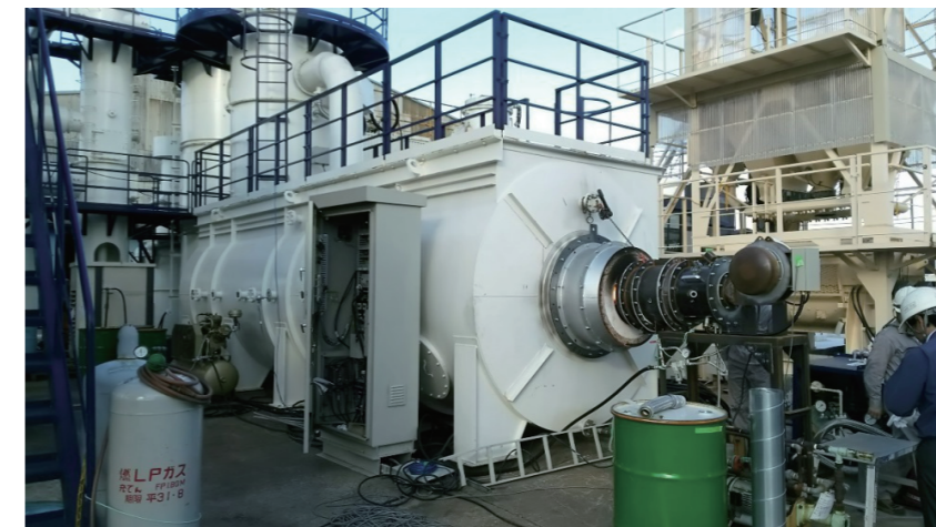
水冷炉と熱出力1/10 微粉炭バーナ
