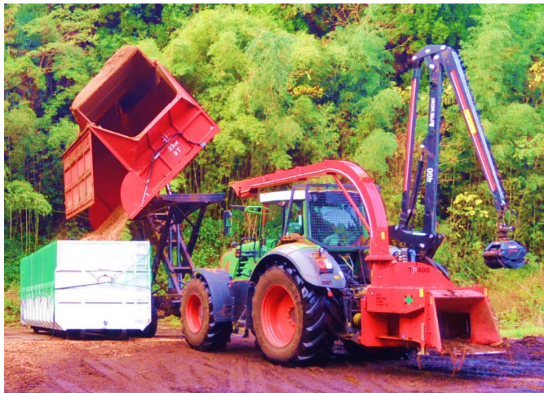
(チップパーと油圧式チップタンクとコンテナの組み合わせ)
