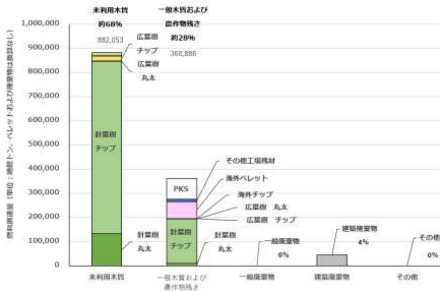
図- 25 「未利用木質バイオマス発電所」の燃料調達量内訳
