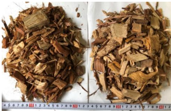
広葉樹針葉樹混合チップ（切削） ドラム型チップパーを利用 左：乾燥前 右：乾燥後
