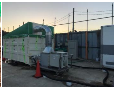
熱源ホース・乾燥コンテナ・ 熱回収システム・ ファンユニット
