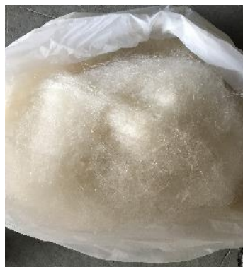
短繊維CNF1.0%（左側）及び長繊維CNF1.0%（右側）コンパウンドより紡糸した繊維
