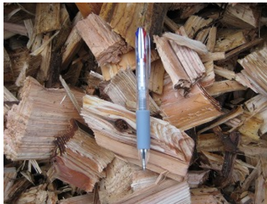
図－17 ガス化発電向けの特種なサイズのチップ（600～1800 mm）
