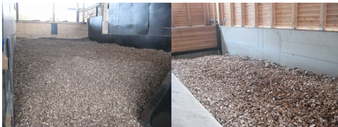
図-21 ガス化発電施設における排熱を利用したチップ乾燥機の例 (Spanner、Urbas)
