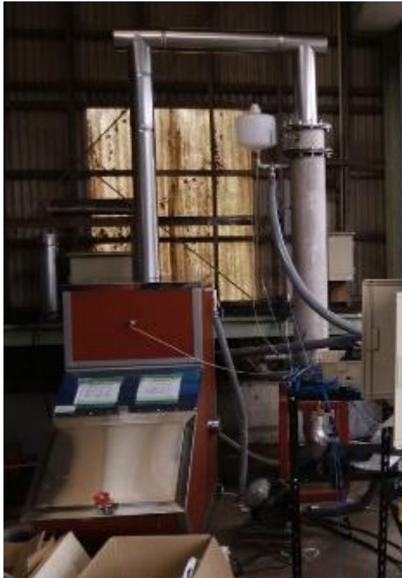
水冷熱交換器の容量 35kW (30,000kcal/時)
