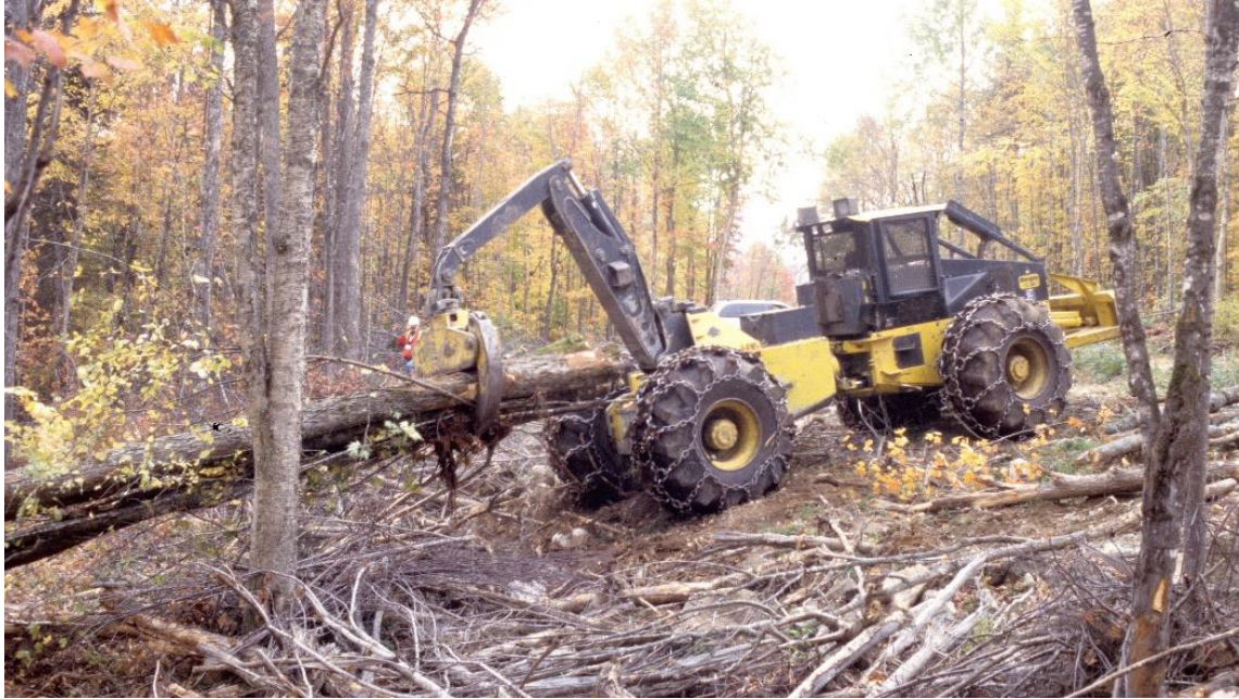
図 27 スキッダによる全木集材の様子
