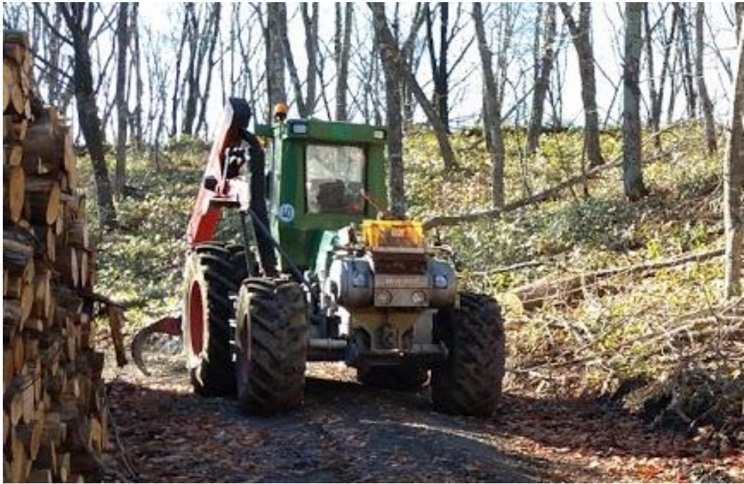
図 7 林業用トラクターによる全木集材
