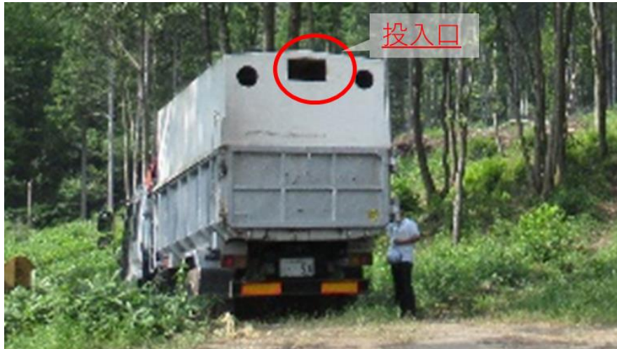
図 12 チップが飛散しないよう開発された FRP 製の屋根
