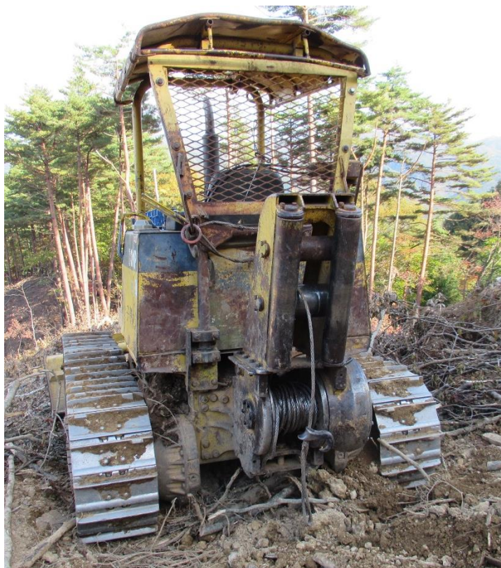
図 6 全木集材に使用されていたウィンチ付ブルドーザー
